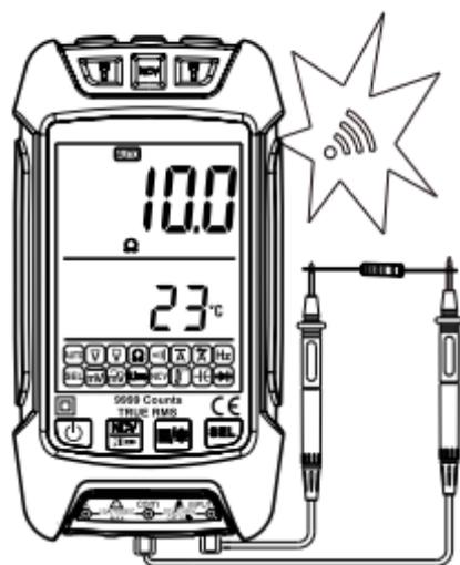
**Nota:** Si el medidor está abierto o la resistencia de la línea medida es superior a  $999.9\ \Omega$ , se muestra "OL".
