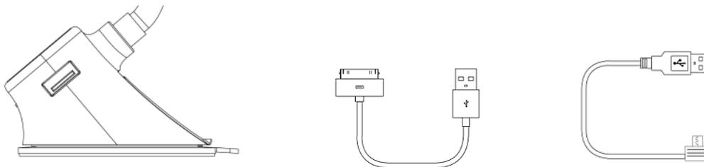
2. Al costado del conector 12 V que se conecta al auto se encuentra un conector micro USB de 5 pines con salida 5V/2.1A que también se puede utilizar para cargar el teléfono móvil y otros dispositivos.
