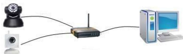
Figura 10 Conexión entre varias cámaras IP y routers
