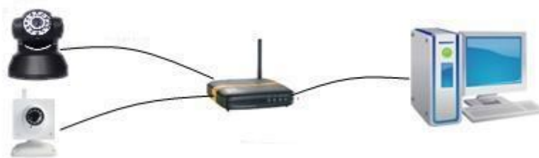
Figura 10 Conexión entre varias cámaras IP y routers
